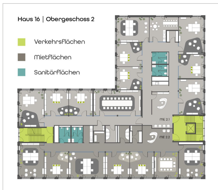
Grundriss – mit Ausbaubeispiel 2. OG
